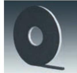
**Anwendungsbereich:** Vorkomprimiertes, selbstexpandierendes Fugendichtband aus feinzelligem Polyurethan-Weichschaum mit integrierter 2-Stufen-Dichtung und Seitenflächenimprägnierung. Zur schlagregensicheren Abdichtung aller Anschlussfugen zwischen WDVS Dämmplatten und dem Baukörper bzw. Bauteilen, z. B. Fenster-, Türrahmen, Dachüberstände, Balkone, Dachgesimse usw..
