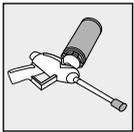
5. Dose für kurze Pausen mit anschließender Weiterverarbeitung auf der Pistole belassen und die Düse schließen (stehend auf der Dose lagern)
