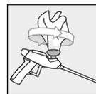
7. Das Ventil der Pistole wiederholt mit einem sauberen Tuch reinigen
