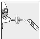
7. Ausgehärtete Schaumüberstände mit einem Cuttermesser entfernen
