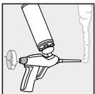
3. Austrittsmenge durch Betätigen der Dosierschraube einstellen und den Schaum im Strangverfahren verarbeiten
