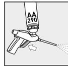
4. Abzugshebel betätigen bis der Reiniger durch die Düse sprüht
