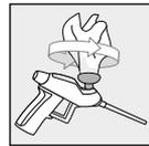
2. Das Ventil der Pistole mit einem sauberen Tuch reinigen
