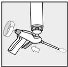
2. Abzugshebel und Dosierschraube an der Pistole betätigen
